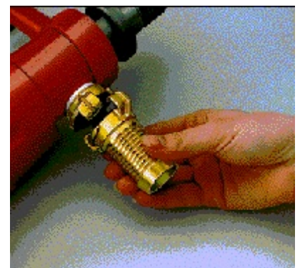
Saugtülle ankuppeln - bereit zum Trockenbohren
