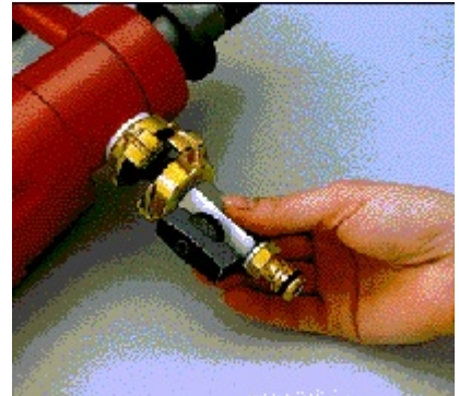
Kugelhahn ankuppeln - bereit zum Nassbohren
